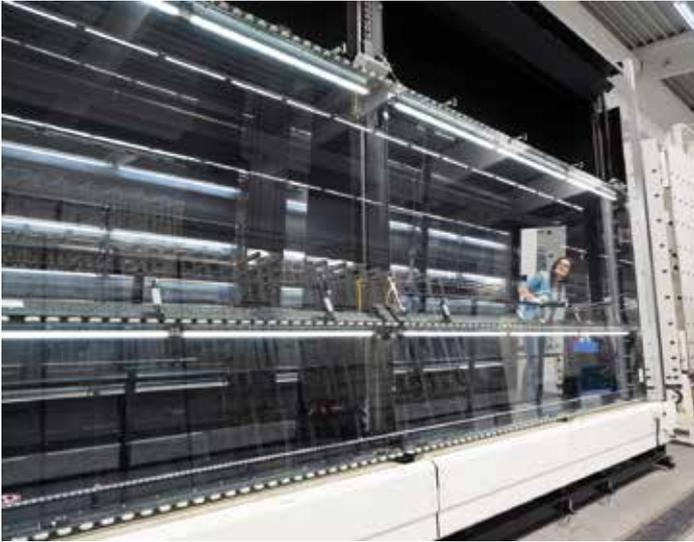
Auf der Suche nach einem Beschichtungsfehler auf der insgesamt 145m langen Isolierglaslinie.
