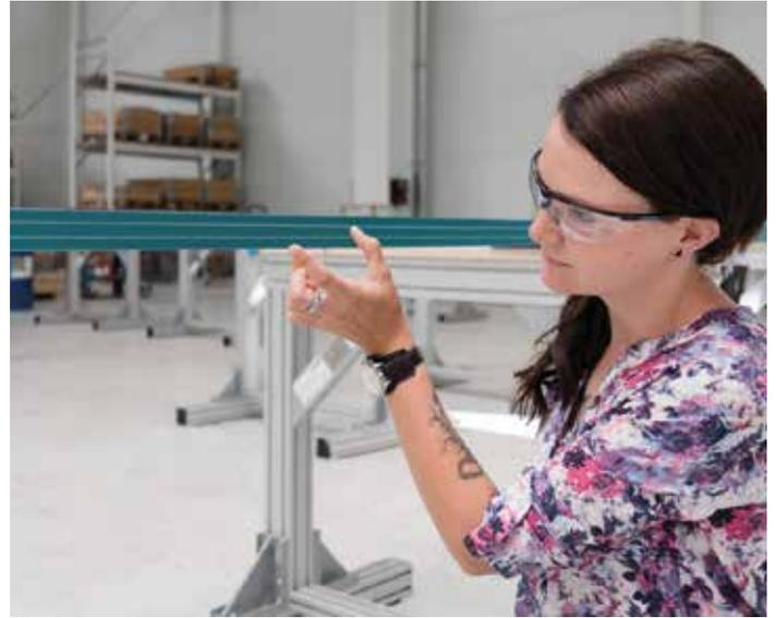
Prüfung der Kantenqualität, bevor das Laminat verpackt wird.
